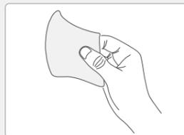
4. Retire la parte posterior de la cinta adhesiva del soporte, sin tocar la parte adhesiva de la cinta ni la superficie de la pared.
