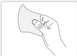
3. Retire la parte posterior de la cinta adhesiva del soporte, sin tocar la parte adhesiva de la cinta ni la superficie de la pared.
