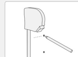
2. Percez les trous sur une profondeur de perçage minimale de 40 mm. Insérez les chevilles dans les trous en tapant avec précaution avec un marteau.
