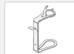
5. Positionnez le support vers les trous de perçage, pressez l'ensemble du support contre le mur et assurez-vous que le ruban adhésif adhère à la surface. Montage avec les vis incluses fixant le support dans les chevilles.
